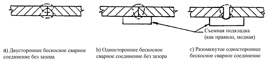
Рис. 1 - Основные типы продольных стыковых сварных соединений
